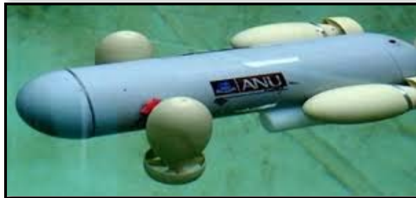
Gambar - 2. Sistem Propeller Kapal Selam
