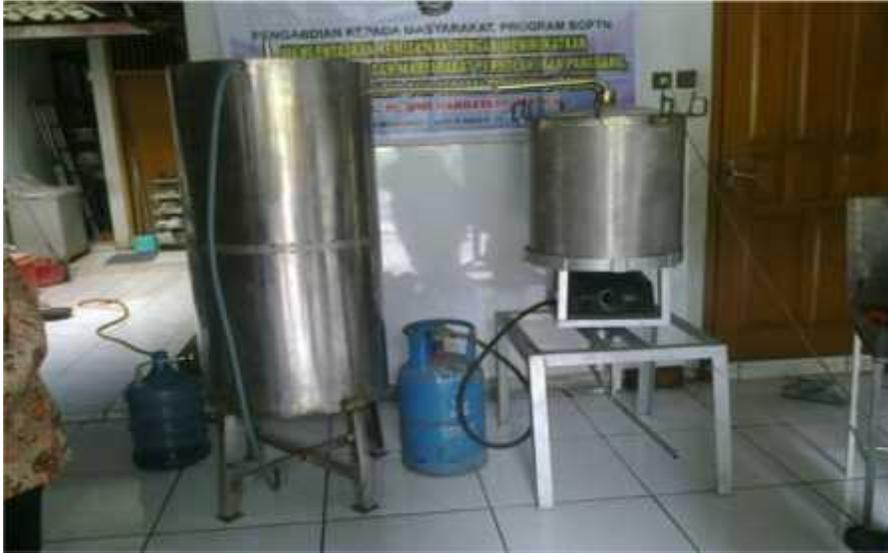
Gambar 2. Hasil Pabrikasi Peralatan Pembuatan Asap Cair
