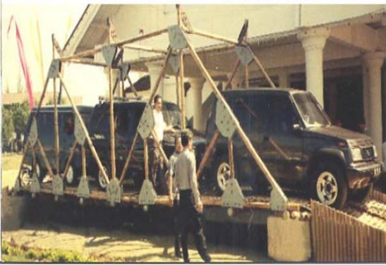
Gambar 6. Pengujian konstruksi jembatan bambu (Morisco, 2006)
