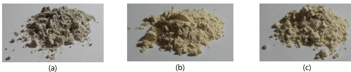
Gambar 2. Hasil Sintesis Nano ZnO-Ag dengan Variasi Suhu Kalsinasi (a) Suhu Kalsinasi 400°C, (b) Suhu Kalsinasi 500°C dan (c) Suhu Kalsinasi 600°C
