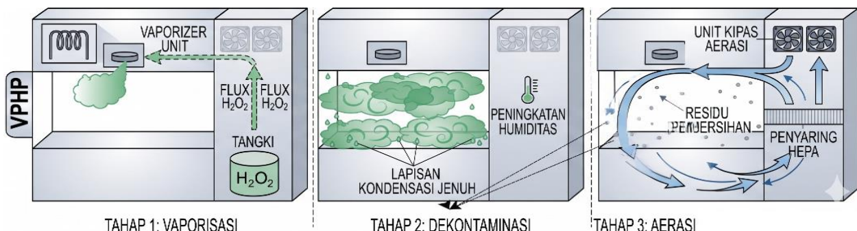
Gambar 1. Ilustrasi proses dekontaminasi dengan penguapan H_2O_2 .
