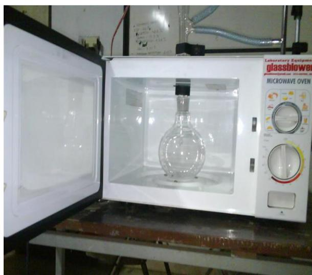
**Gambar 2.** Hasil rancangan dan pabrikasi ekstraktor reaktif gelombang mikro
