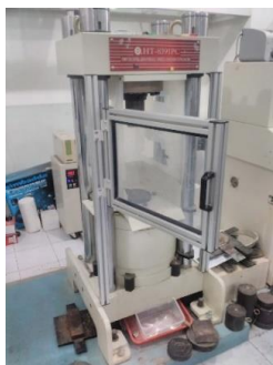
Gambar 6. Alat uji tekan mortar
