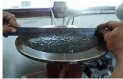
Gambar 2. Pengukuran diameter dengan di atas meja leleh ASTM C-230
