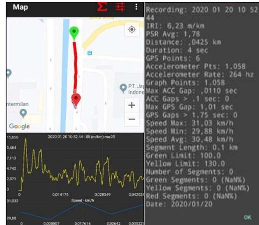
Gambar 3. Grafik dan nilai IRI rata-rata perkerasan pracetak
