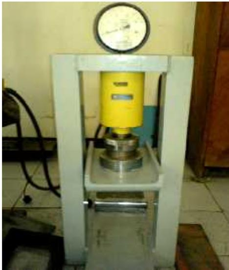
Gambar 3. Pengujian dengan *Compression Test Apparatus*
