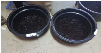
Gambar 4. Proses perendaman serat ijuk diameter 0,3 mm dengan air laut
