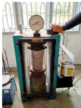
Gambar 6. Pengujian kuat tekan beton SCC
