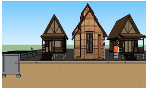
Gambar 7. Perencanaan alat pemanen air hujan tipe komunal yang memerlukan system perpipaan pengumpul dan distribusi
