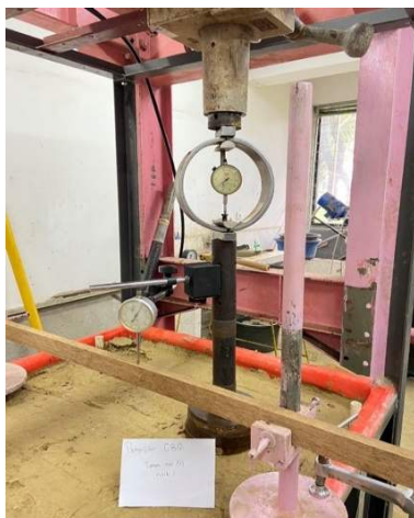
Gambar 3. Pengujian CBR pada tanah dalam bak uji
