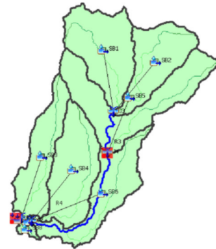
Gambar 11. Skematik pemodelan HEC-HMS untuk kalibrasi
