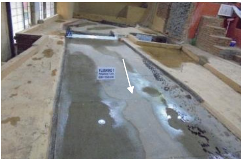
Gambar 8. Sedimen yang terangkut dan tertahan di bagian hilir bendung
