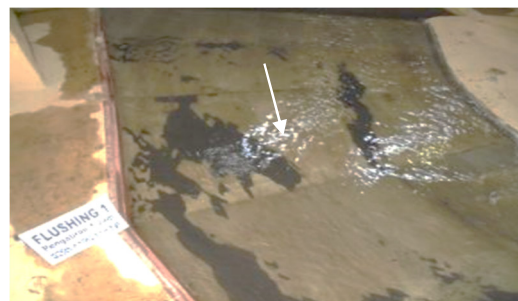
Gambar 6. Perubahan endapan sedimen hulu dengan durasi pengaliran debit selama 1 jam
