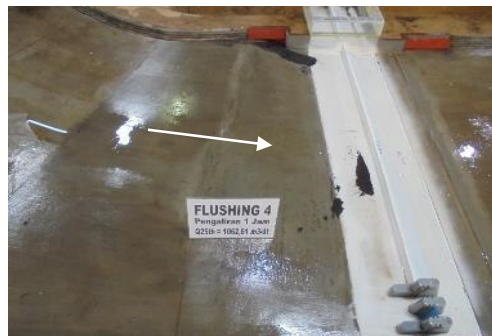
Gambar 12. Endapan sedimen di hulu bendung
