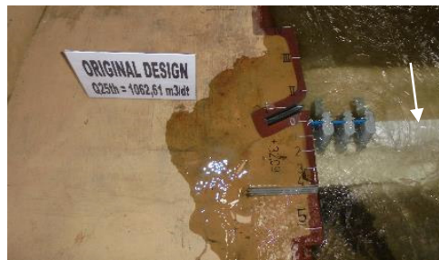
Gambar 4. Kondisi luapan pintu pembilas model fisik hidrolis di labortarium
