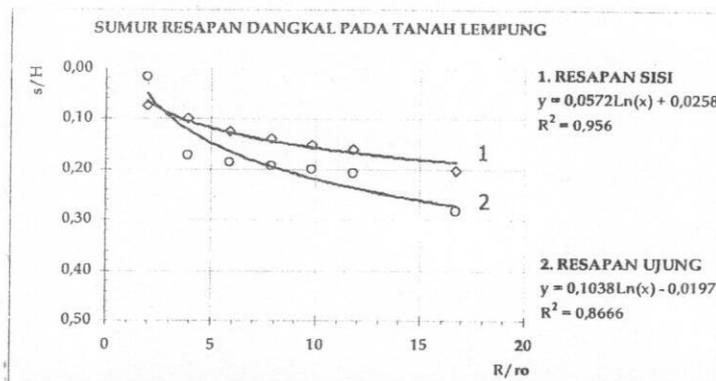
Gambar 5. Lengkung depresi tekanan muka air sumur resapan dangkal pada tanah lempung
