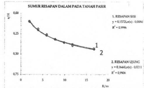
Gambar 6. Lengkung depresi tekanan piezometrik sumur resapan dalam pada tanah pasir
