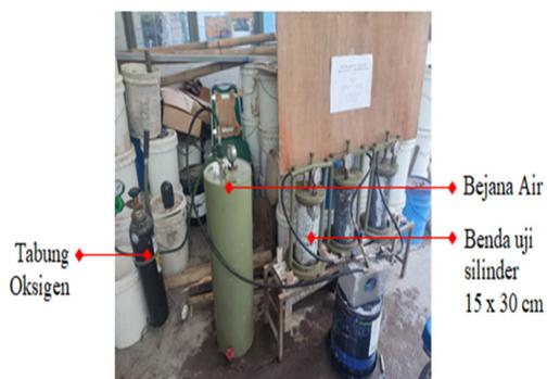
**Gambar 2. Pengujian Permeabilitas**
