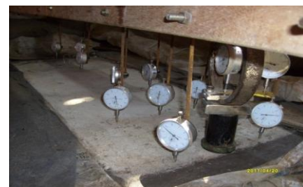
Gambar 3. Foto uji model pelat terpaku dengan 2 baris tiang untuk beban di ujung pelat
