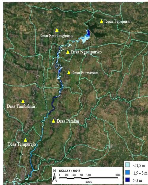
**Gambar 14. Peta genangan dengan  $Q_{PMF}$  tanpa keruntuhan bendungan**
