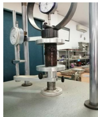
Gambar 6. Pengujian kuat tekan bebas pada spesimen uji sampai dengan runtuh
