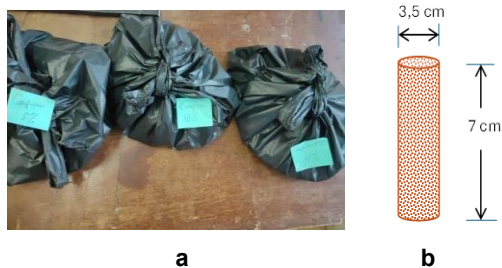
Gambar 4. Contoh tanah yang telah dicampur serbuk cangkang kerang darah di simpan dalam plastik (a), Ilustrasi spesimen uji kuat tekan bebas (b)
