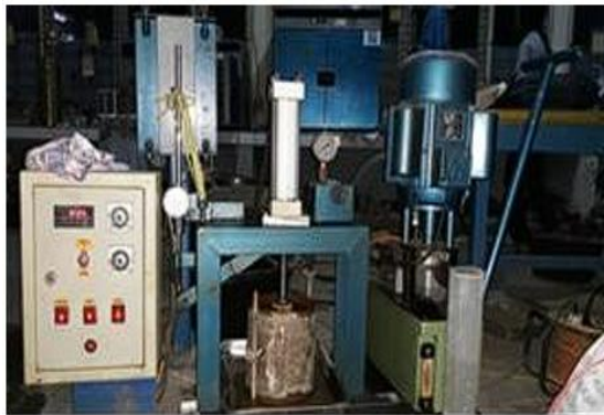
Gambar 2. Alat uji beban siklik
