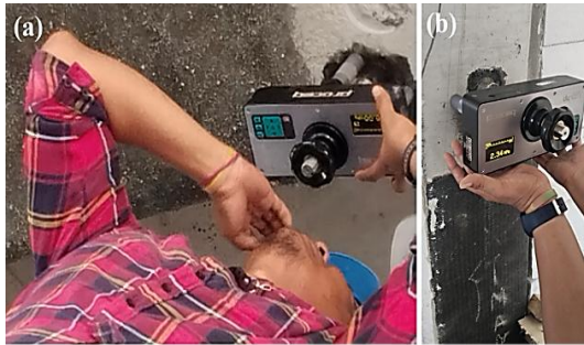
Gambar 10. Uji pull-off untuk mengevaluasi kuat lekat FRP (a) pada balok, dan (b) pada kolom yang dilakukan perkuatan
