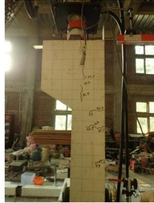
Gambar 6. Pola retak benda uji kolom monolit tanpa sambungan
