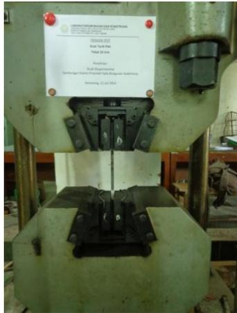
Gambar 2. Set up pengujian kuat tarik baja
