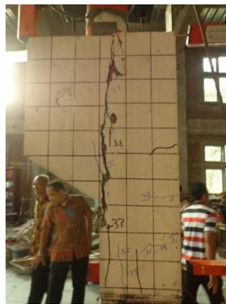
Gambar 7. Pola retak benda uji kolom dengan sambungan
