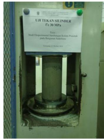
Gambar 3. Set up pengujian kuat tekan silinder beton
