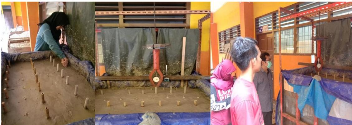
Gambar 2. Uji model tiang dalam bak uji
