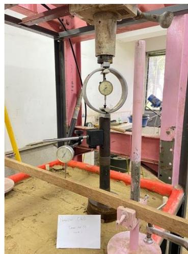
**Gambar 3. Pengujian CBR pada Tanah dalam Bak Uji**
