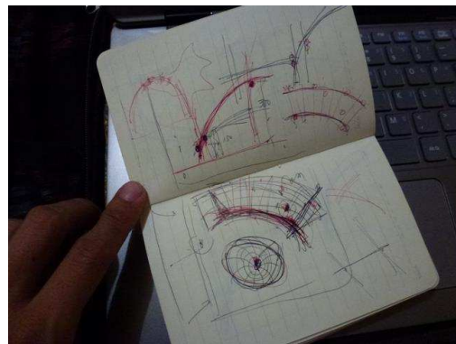
Gambar 3. Sketsa Rancangan. Sketsa struktur balai ajar Tegal Arum oleh Yu Sing, memanfaatkan pohon nangka sebagai kolom dan sumbu utama (Sumber: http://www.facebook.com/notes/yu-sing/balai-ajar-tegal-arum-pangqilan-borobudur/10150798571889119 )
