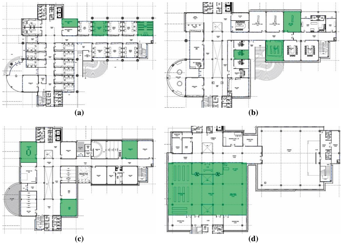
Gambar 3. Area sebagai objek simulasi DiaLux Evo (a) Lantai 1; (b) Lantai 2; (c) Lantai 3; dan (d) Lantai 4
