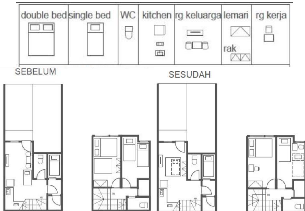
Gambar 5.5 Contoh Template Perabot dan Contoh Data Perubahan Pembagian Fisik Ruang yang terjadi
