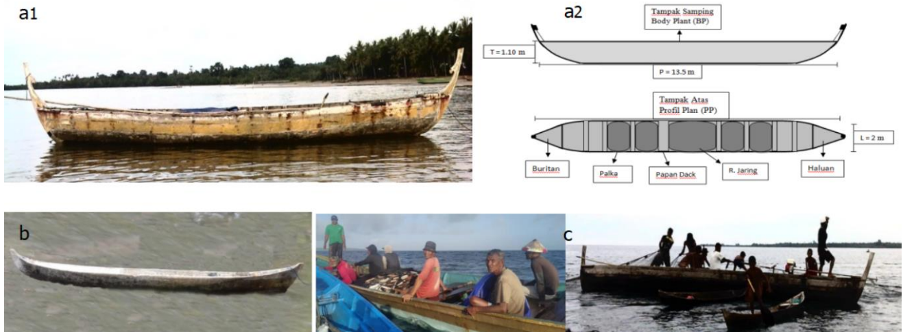
Gambar 3. Kapal mini purse seine (a1) dan konstruksinya (a2), perahu bantu (b), posisi 12 ABK di kapal (c).
