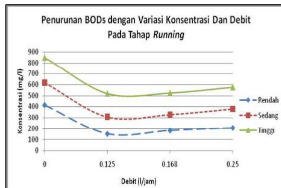
Gambar 4. Penurunan BOD 5 Dengan Variasi Debit dan Konsentrasi Pada Tahap Running
