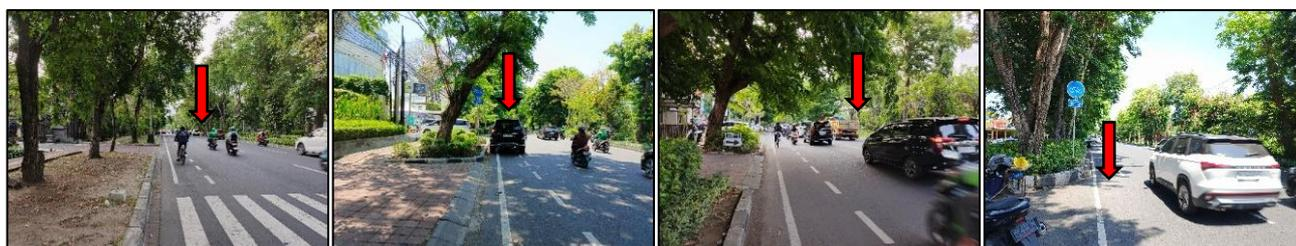
**Gambar 9.** Kondisi Jalur Sepeda Kurang Nyaman dan Tidak Aman (Pesepeda Berbagi Jalur dengan Kendaraan Bermotor; Kendaraan Parkir di Jalur Sepeda; Lalu Lintas Padat; Jalur Sepeda Kurang Peneduh)
