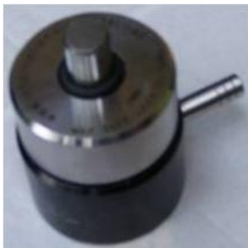
Gambar 1. Cetakan membran LCCF berbahan baja tahan karat.
