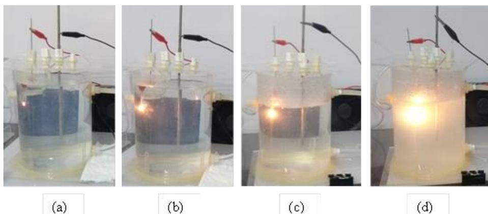
**Figure 3:** Plasma on Variation of Air Injection Flow Rate (a) 0 L.min<sup>-1</sup>, (b) 0.2 L.min<sup>-1</sup>, (c) 0.4 L.min<sup>-1</sup> and (d) 0.8 L.min<sup>-1</sup>
