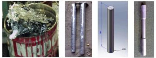
Gambar 6. Benda uji untuk uji tarik.
