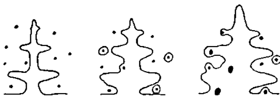
Gambar 2.5 Skematik pertumbuhan austenit-grafit bulat eutektik [3]
