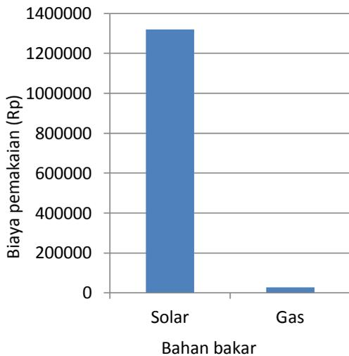
Gambar 2. Grafik perbandingan biaya pemakaian bahan bakar solar dengan gas (Rp/jam)
