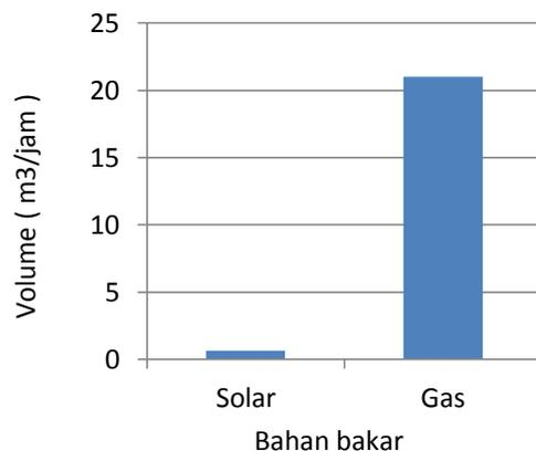
Gambar 1. Grafik perbandingan kebutuhan bahan bakar solar dengan gas (m<sup>3</sup>/jam)
