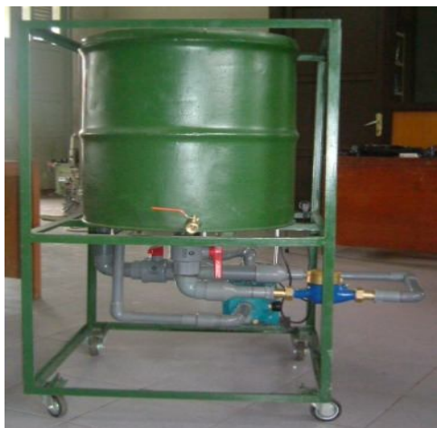
Gambar 11. Sistem umum quenching dengan air tersirkulasi
