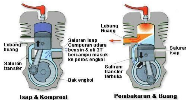
Gambar 1. Sistem pembakaran 2 langkah [no referensi]
