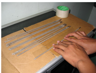
Gambar 10. Proses pelapisan elektroda dengan selotip
