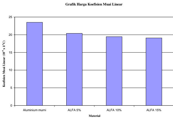
Gambar 10. Grafik pengaruh penambahan fly ash terhadap harga koefisien muai linear aluminium
