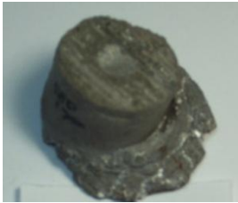
Gambar 4.5. Percobaan dengan temperatur T = 570\text{ }^{\circ}\text{C} dan holding time t = 90 menit
