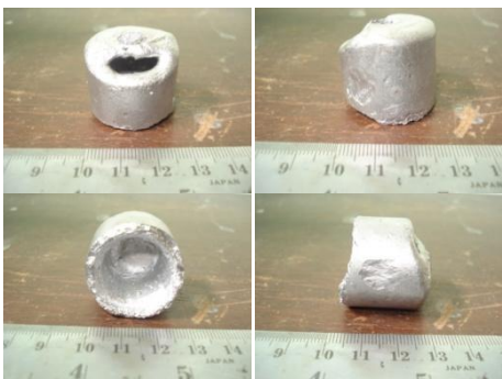
Gambar 4.19. Produk thixocasting dengan temperatur reheating 597 °C holding time 120 menit dan ukuran nosel 9 mm
