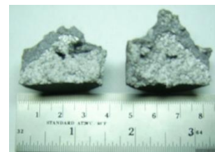
Gambar 4.12. Percobaan dengan temperatur T = 590\text{ }^{\circ}\text{C} dan holding time t = 120 menit
