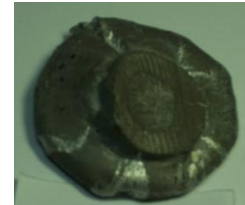
Gambar 4.10. Percobaan dengan temperatur T = 580\text{ }^{\circ}\text{C} dan holding time t = 90 menit
