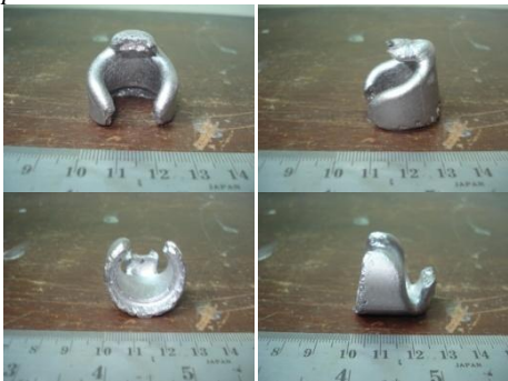
Gambar 4.20. Produk thixocasting dengan temperatur reheating 594 °C holding time 120 menit dan ukuran nosel 8 mm
