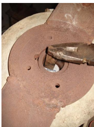
Gambar 3.8. Proses memotong billet pada keadaan semisolidnya dengan menggunakan heater thixocasting
