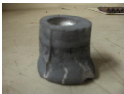
Gambar 4.8. Percobaan dengan temperatur T = 572\text{ }^{\circ}\text{C} dan holding time t = 240 menit
