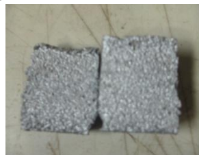
Gambar 4.1. Percobaan dengan temperatur T = 570\text{ }^{\circ}\text{C} dan holding time t = 120 menit
