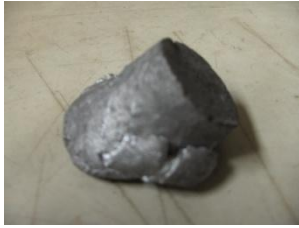
Gambar 4.4. Percobaan dengan temperatur T = 575\text{ }^{\circ}\text{C} dan holding time t = 120 menit
