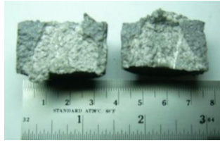
Gambar 4.14. Percobaan dengan temperatur T = 597\text{ }^{\circ}\text{C} dan holding time t = 120 menit
