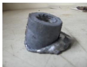
Gambar 4.3. Percobaan dengan temperatur T = 572\text{ }^{\circ}\text{C} dan holding time t = 240 menit
