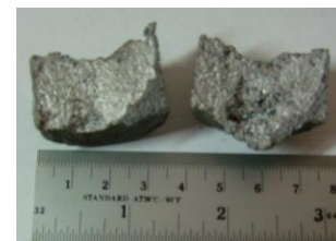
Gambar 4.13. Percobaan dengan temperatur T = 594\text{ }^{\circ}\text{C} dan holding time t = 120 menit
