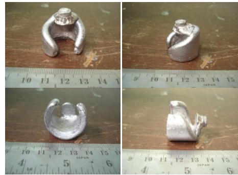
Gambar 4.21. Produk thixocasting dengan temperatur reheating 597 °C holding time 120 menit dan ukuran nosel 8 mm
