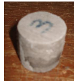
Gambar 4.11. Percobaan dengan temperatur T = 580\text{ }^{\circ}\text{C} dan holding time t = 120 menit
