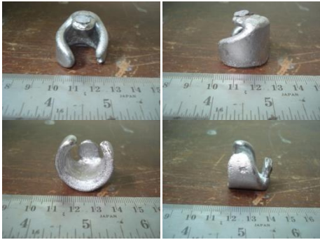
Gambar 4.18. Produk thixocasting dengan temperatur reheating 594 °C holding time 120 menit dan ukuran nosel 9 mm
