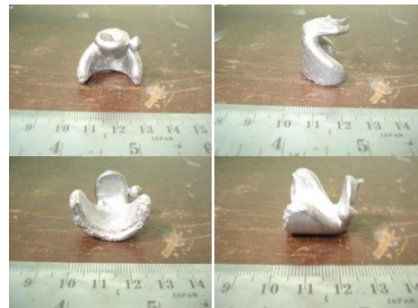
Gambar 4. 22. Produk thixocasting dengan temperatur reheating 594 °C holding time 120 menit dan ukuran nosel 9 mm
