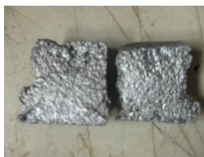
Gambar 4.2. Percobaan dengan temperatur T = 572\text{ }^{\circ}\text{C} dan holding time t = 120 menit
