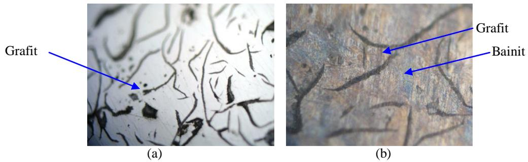
Gambar 6. Struktur mikro besi cor kelabu paduan 0.3% Cr tanpa perlakuan panas ; (a) aspolish, perbesaran 500x dan (b) etsa, perbesaran 1000x.
