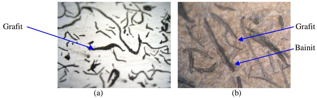
Gambar 5. Struktur mikro besi cor kelabu non paduan dengan austemper 300 °C ; (a) aspolish, perbesaran 500x dan (b) etsa, perbesaran 1000x.
