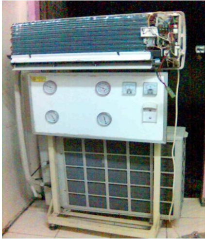
Gambar 1. AC Split untuk pengujian
