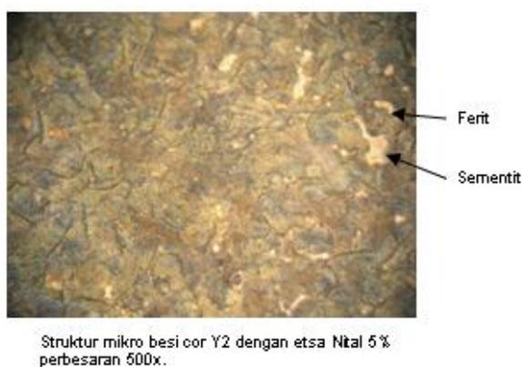
Gambar 5 Struktur mikro besi cor hasil cetakan pasir
