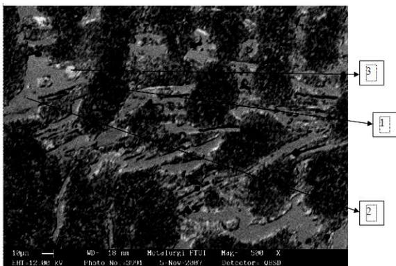
Gambar 5. Struktur mikro ball mill diameter 70 mm dengan pembesaran 500 kali
