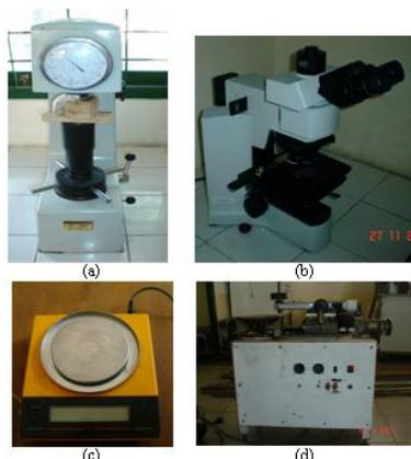
Gambar 2. (a) Alat uji kekerasan (b) Mikroskop (c) Timbangan digital (d) Alat uji keausan
