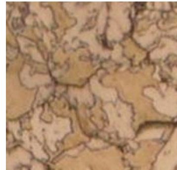
Gambar 8. Struktur mikro baja ST-90 Austemper Dua Tahap dengan TA1 450° C dan TA2 500° C. Perbesaran 1000X. Nital 2%. Terbentuk karbida selain karbida besi ( cementite ), sebagai hasil dari Secondary Hardening .
