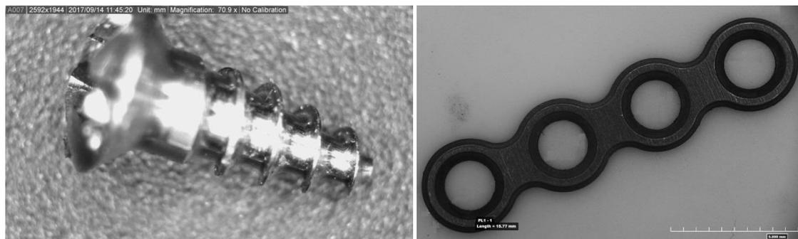
Gambar 4. Hasil akhir prototipe: *screw* (kiri) dan *miniplate* (kanan)
