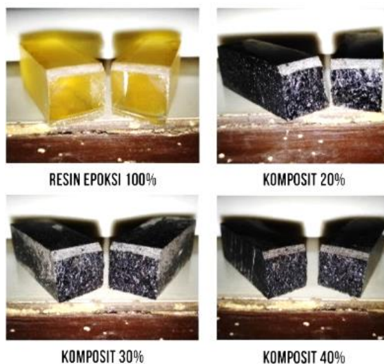
Gambar 8. Bentuk patahan spesimen setelah uji impact
